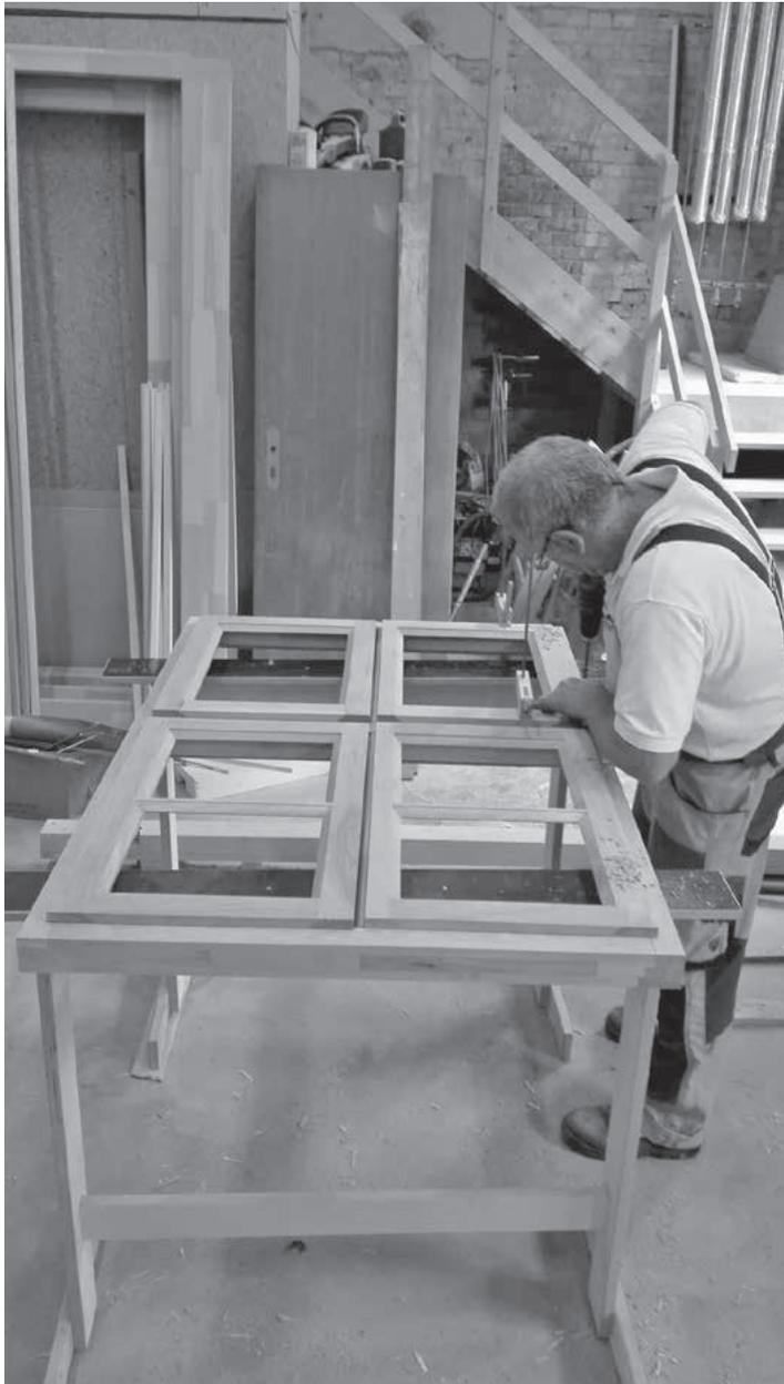
*Sauber gearbeitet und dem Original nachempfunden, zugleich immer auf dem aktuellen technischen Stand – Denkmalschutzfenster von der Bau Tischlerei Evers.*
